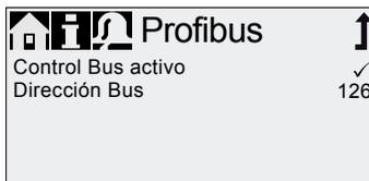
Fig. 39 Ejemplo de submenú para Profibus®
